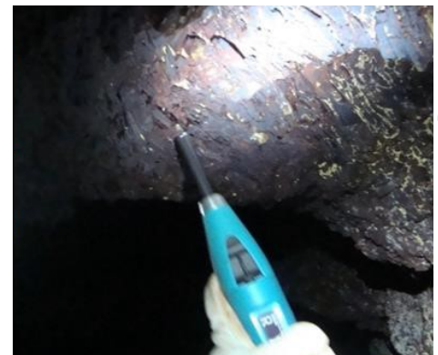
Martelo Schmidt utilizado durante o ensaio
