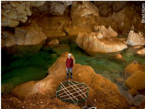
A antena é feita de um fio e pequenos tubos de PVC
